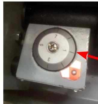
La roue à utiliser, ou même l'indication qu'il n'y a pas besoin de l'appareil à retomber dans le pas est donnée par la table figurant sur le corps de celui-ci.
